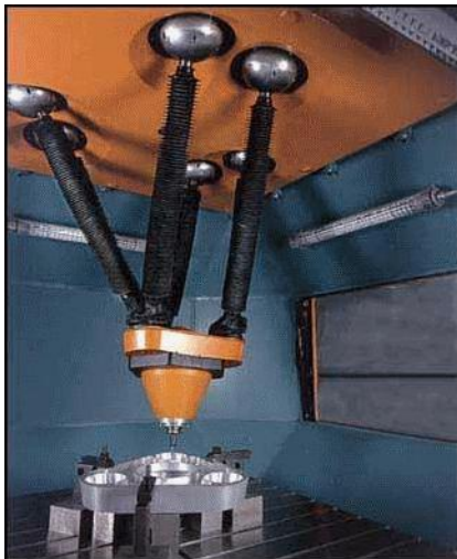
Рисунок 7 – Верстат HEXEL (США) (а) та робоча зона механізму з паралельною кінематикою типу «гексапод»
